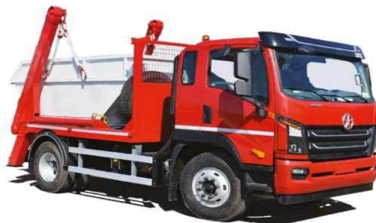
Рис. 43 Сміттєвоз СВ302.3 на шасі Dong Feng
