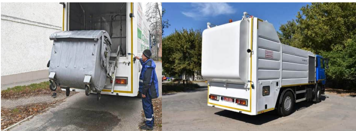
Рис.20 Мобільна мийка контейнерів АТ МК-0103 на базі шасі МАЗ 5340С2
